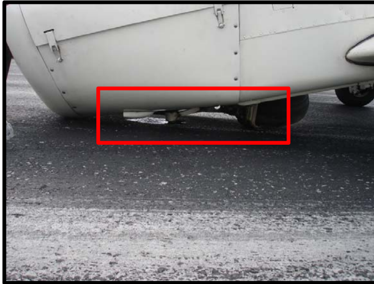
Fotografía No. 3 Tren de Nariz quebrado
