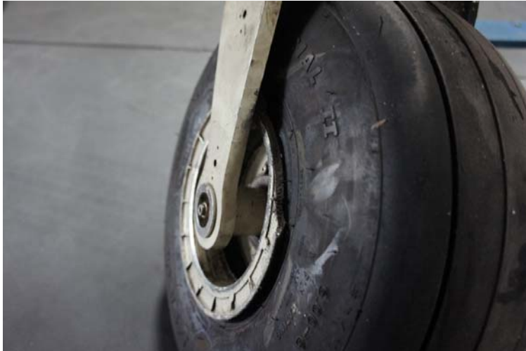
Fotografía No. 13 Aro o rin fracturado por compresión.
