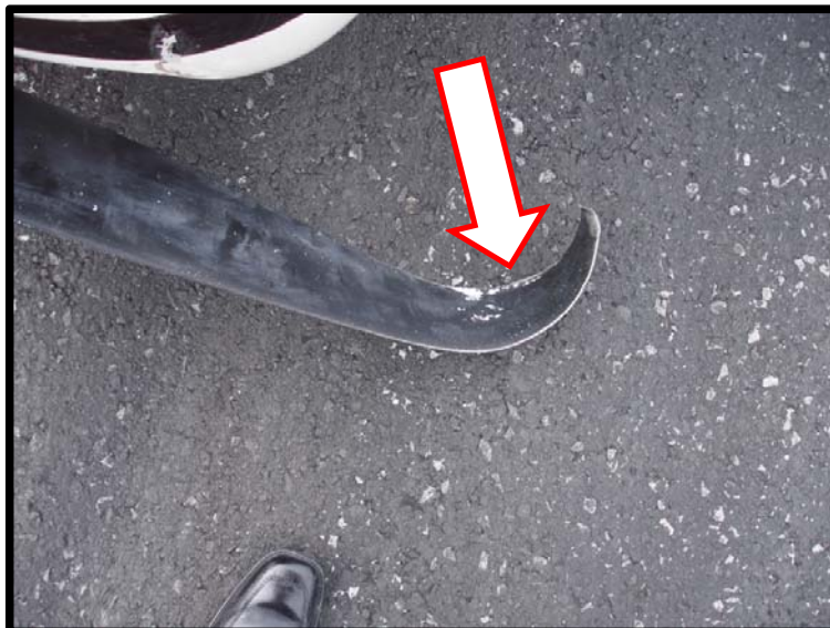
Fotografía No. 4 Daños en una de las aspas de la hélice.
